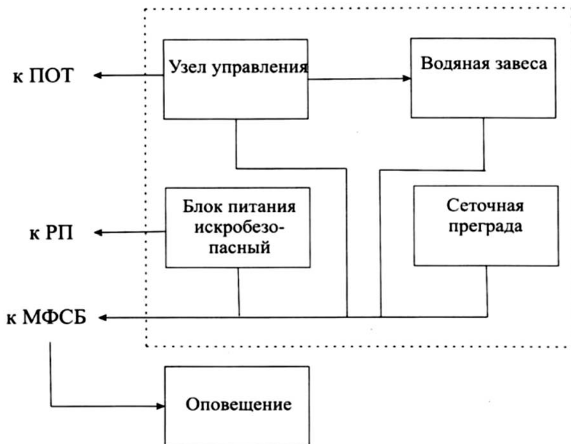
Рис. 1. Блок-схема подключения АВЗ:
